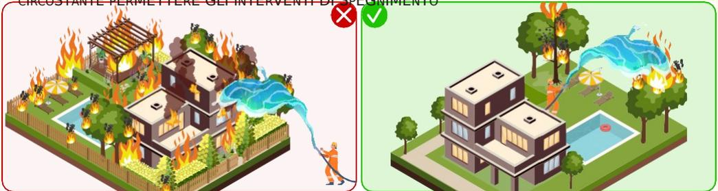
**La fascia che ricade nel raggio di 30 metri intorno alla costruzione è principalmente responsabile della trasmissione della propagazione e dell'intensità potenziale dell'incendio e dell'innesco della stessa così come della propagazione di un possibile innesco verso l'esterno**
