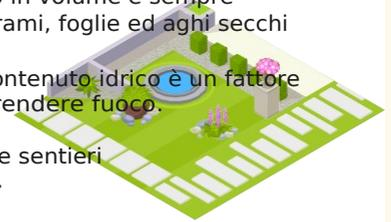
Le siepi sono spesso la via d'entrata del fuoco nella proprietà - effetto miccia. Evitare siepi che terminano adiacenti all'abitazione e mantenerle sempre ad una distanza > 5 m. Mantenerle le siepi ad una distanza dagli alberi pari almeno a 2 volte l'altezza della siepe stessa. Mantenerle basse (<2m), correttamente potate e ripulite dalle secche che si accumulano anche internamente, anche a causa di potature troppo intense e frequenti.
